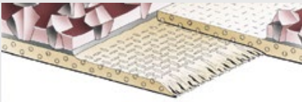
Overlappende las met korrelafslijping
