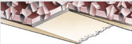
Overlappende las zonder korrelafslijping
