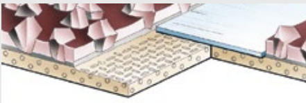
Gesloten las met speciale folie aan korrelzijde
