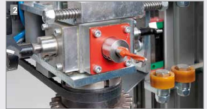
Linkse boor van 5 mm voor rijboringen
