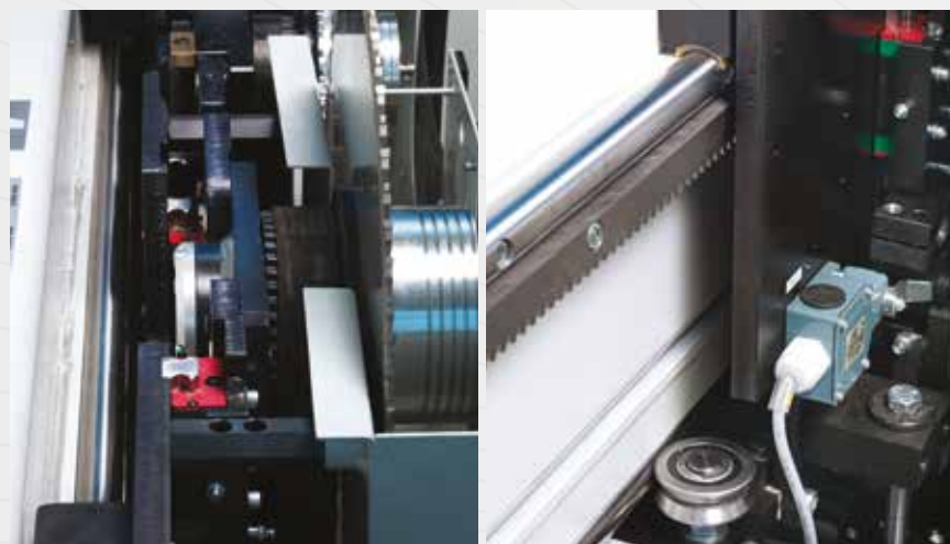
Salita lame indipendenti su guide con pattini a ricircolo di sfere. Avanzamento del carro lame con sistema pignone e cremagliera e scorrimento del carro su guide cilindriche Independent rising of blades on guides with recirculating ball. Saw carriage movement with rack and pinion system and carriage sliding on cylindrical guides. Subidas de las sierras independientes sobre guías con patines de bolas. Avance del carro de las sierras con sistema de cremallera y piñón y deslizamiento sobre guías cilíndricas Unabhängiger Sägeblattantrieb auf Führungen mit Kugelzirkulations-Gleitblöcken. Sägewagenvorschub mit Ritzel und Zahnstangensystem und Gleiten des Sägewagens auf zylindrischen Führungen Montée lames indépendantes sur guides avec recirculation de billes. Avancement du chariot porte-scie par crémaillère et pignon et déplacement du chariot sur des guides cylindriques à billes.
