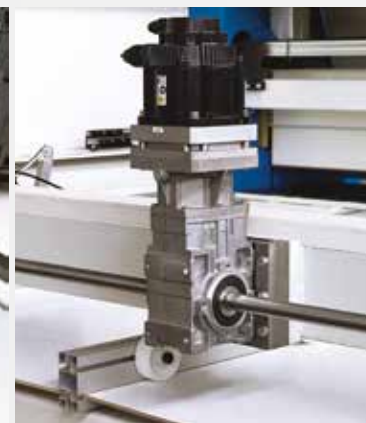
Motorizzazione spintore con Brushless e riduttore a ingranaggi (opt.) Brushless motor for pusher with reduction gear (opt.) Motor Brushless del empujador con reductor de engranaje (opt.) Brushless-Schiebomotor mit Untersetzungsgetriebe (auf Wunsch) Moteur Brushless du pousseur avec réducteur à engrenages (opt.)
