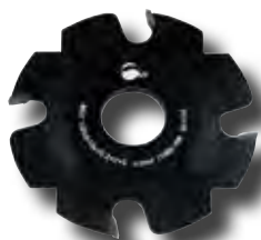
1 fraise à rainer réf.937.120.30.0510 Ø 120 x 30 x 5/9,5 HM Z4+V4
