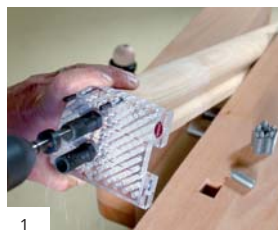
1. Bout positioneren en handlijst boren
