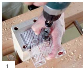
1. Bout positioneren en poot boren
