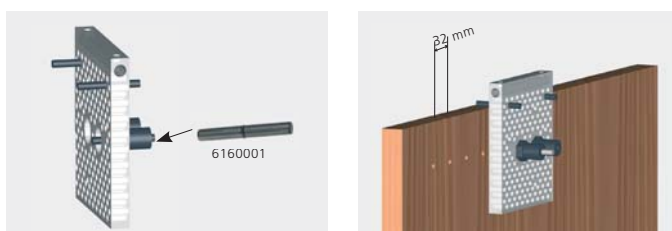
Rijboringen \varnothing 5 mm in een 32 mm raster
