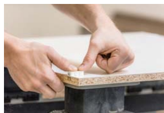
2. Eendelige verbinder aanbrengen
