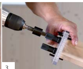
3. Met dezelfde instelling van de bouten de andere kant boren
