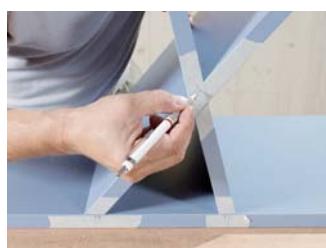
2. Midden op het tweede werkstuk overbrengen
