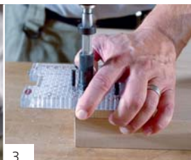
3. Met dezelfde instelling van de bouten het blad boren
