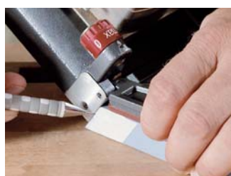
1. Frezen en midden van de frezing markeren
