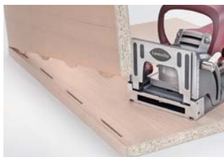
Verbindingen met lamellen
