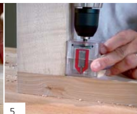
5. Verbinden met MiniMag Mx2
