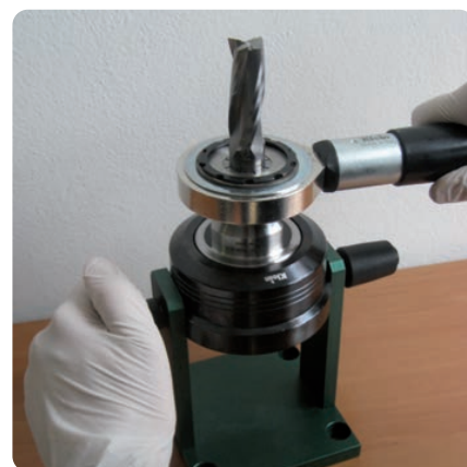
Serraggio ghiera con chiave dinamometrica Art Z052 pag. 10.08
