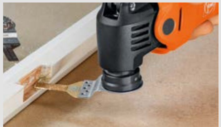
Uitsparingen zuiver en nauwkeurig uitvijlen.
